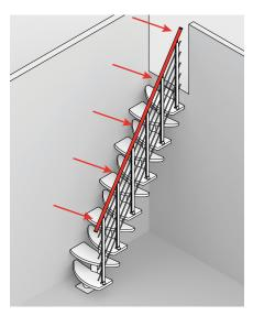
LOAD ON HANDRAIL Max. 0,5 kN/m ~ 50 kg/m
